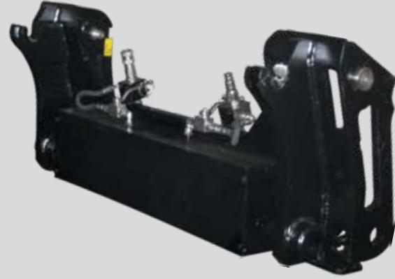
Der Schnellwechsler M3 ohne Änderung der Schaufel ermöglicht die Verwendung von jeder Art von Geräten und eliminiert vollständig die Zeiten zum Auswechseln der Ausrüstung. Er kann auf alle Baggerlader montiert werden, vermeidet jede Art von Intervention in die Werkstatt und erhöht deutlich die Produktivität der Maschine.
