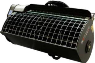
Helices en acier anti-usure 450HBW Goulotte de déchargement longeur 1500 mm Groupe de joints en acier fritté
