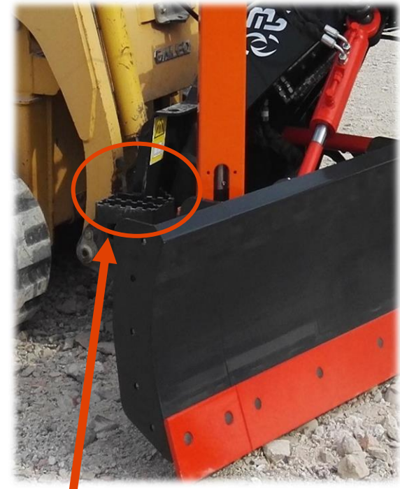
Escalón de acceso a la mini cargadora
