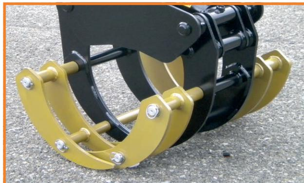
La pinza da tronchi M3 serie leggera senza lama è costruita interamente in acciaio FE 510. Fornita con cilindro orizzontale, foratura standard superiore e rotazione idraulica a 360°.
